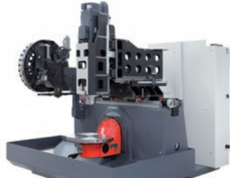
MAXXMILL 630: öntöttvas és hegesztett acél gépszerkezet
