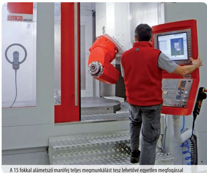
A 15 fokkal alámetsző marófej teljes megmunkálást tesz lehetővé egyetlen megfogással
